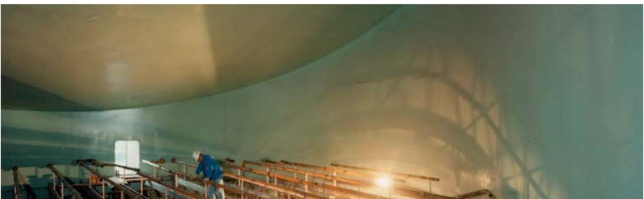
上图：在浮式气体洗涤厂中的涂层吸收器头。
